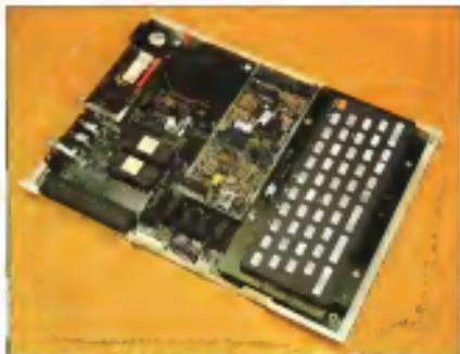
Il sistema di MPF aperto: a destra la tastiera mobile in plastica; a sinistra l'unità centrale dotata di computer integrato e di posizione relativa; all'opposizione di spazio in un mobile integrabile con i vari altri al monitor e all'alimentazione.
